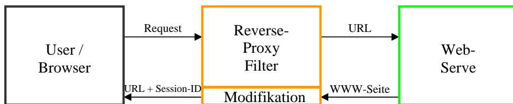
Abbildung 6: Funktionsweise des Reverse-Proxy-Filtersystems
